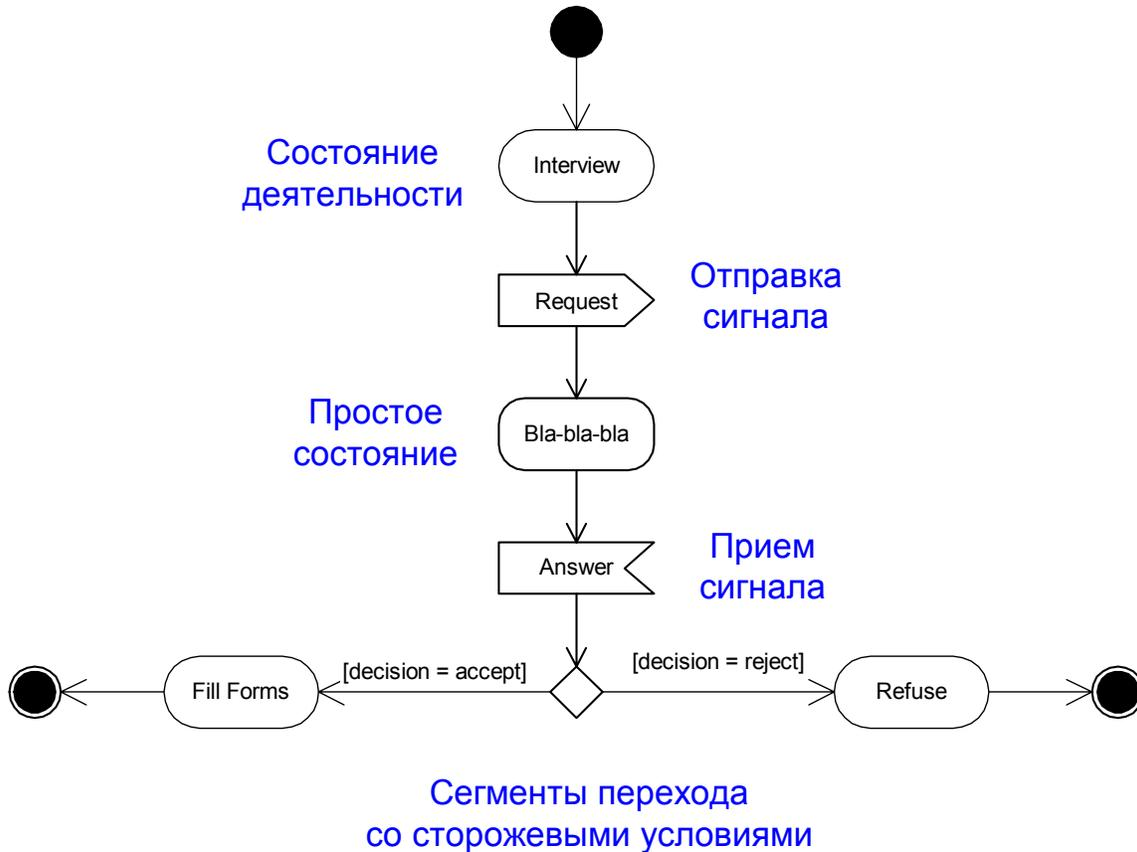
Рис. 4.46. Специальные обозначения для отправки и приема сигналов
