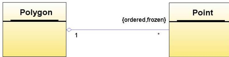
**Рис. 3.19.** Упорядоченность и изменяемость множества объектов на полюсе связи
